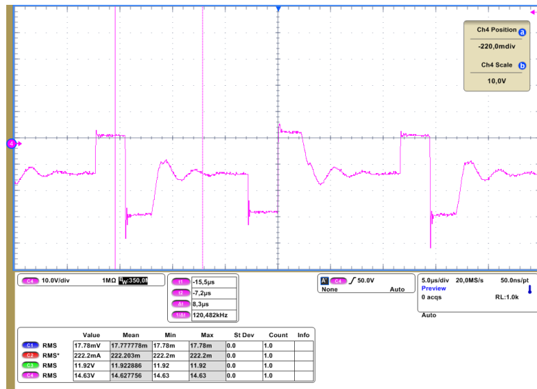
Figura 4.7: Salida de unos de los secundarios del transformador (previo al diodo Schottky) correspondiente a la salida de -15V.
