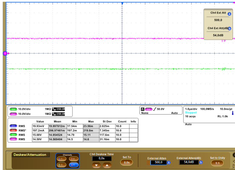
Figura 4.8: Tensiones de +/- 15V a la salida
