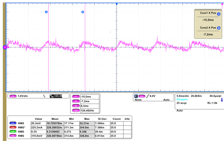
Figura 4.4: Vista ampliada del rizado de 120Hz a la salida del puente rectificador.
