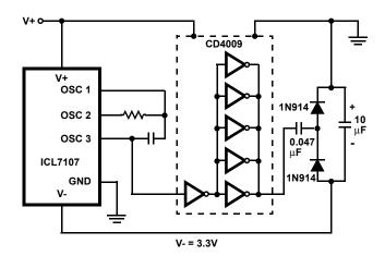
FIGURE 10. GENERATING NEGATIVE SUPPLY FROM +5V
