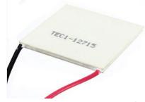
**Descripción:** Es una celda termoeléctrica que sirve para enfriar o calentar un objeto, ideal para experimentos y proyectos de control de temperatura. Cuando la celda se polariza, una cara emite calor y la otra absorbe calor. Si se polariza inversamente, la cara opuesta se enfría y viceversa Estos dispositivos deben usarse en conjunción con un disipador de calor para evitar sobrecalentamiento y quemaduras.
