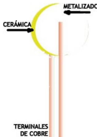
Este tipo de capacitor se provee desde capacidades de 2,2 pF hasta .1 $\mu$ F en tensiones relativamente bajas de 63V. Existen también capacitores cerámicos disco de mayor tensión para aplicaciones especiales que llegan a valores de 2KV.
